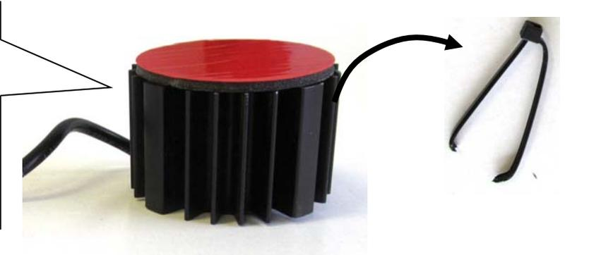
Originale Dämpfersteuerungsleitung in die mitgelieferten Stilllegung einstecken. Auf die korrekte Verriegelung des Steckers achten! Stilllegung mit dem mitgelieferten Klebe pad an der Fahrzeugkarosserie befestigen.
