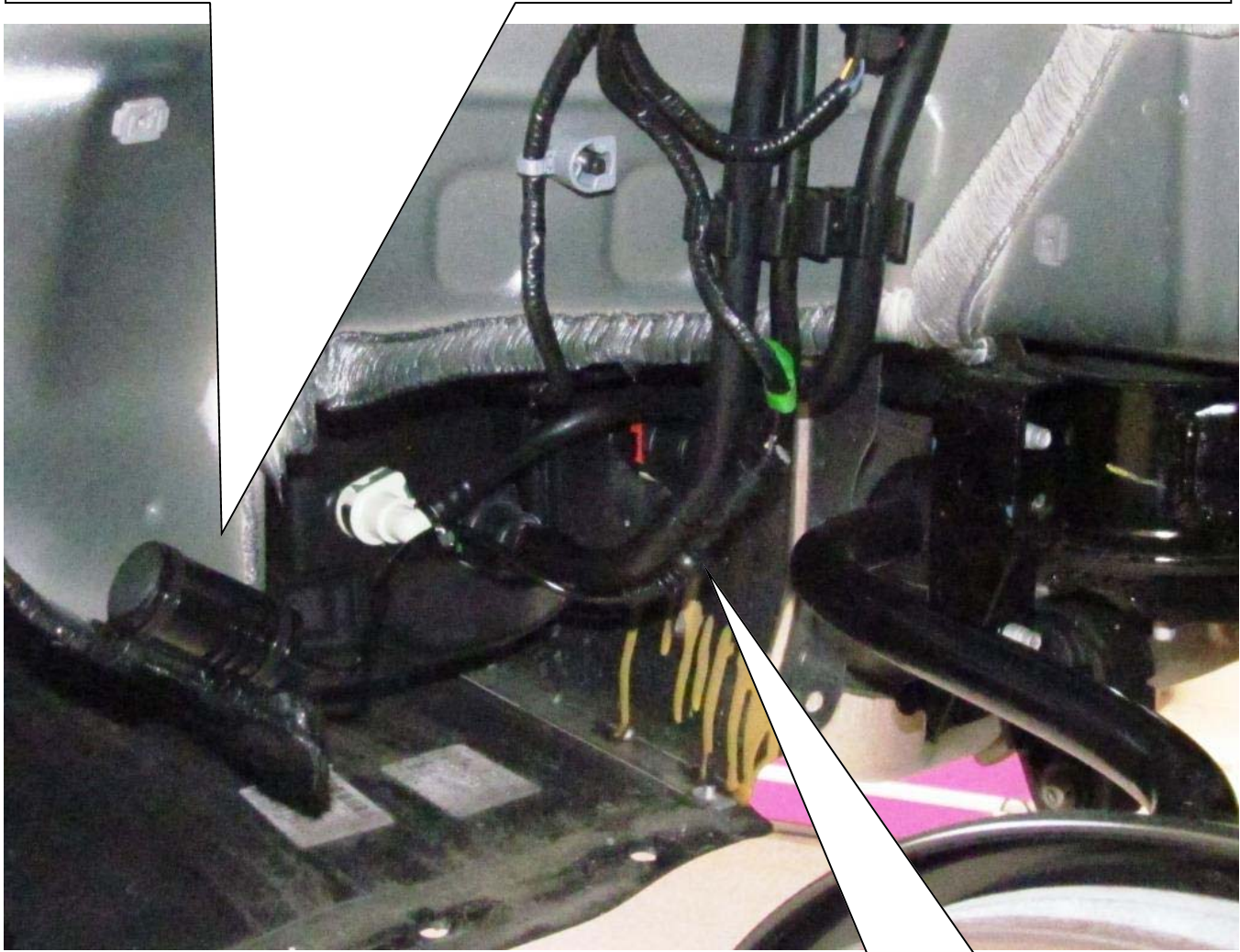
Original Kabel mit Kabelbindern befestigen. Fix the OEM wire with cable ties.
