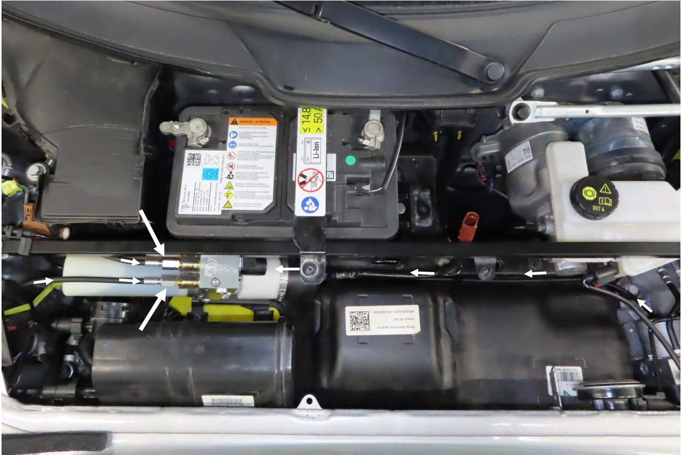
Korrekt aufgesteckte Hydraulikleitung / Correctly connected hydraulic line
